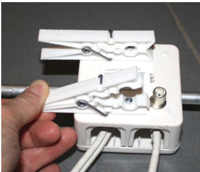
Scatola del dipolo e mollette forate. Il BNC può essere posizionato diversamente!
