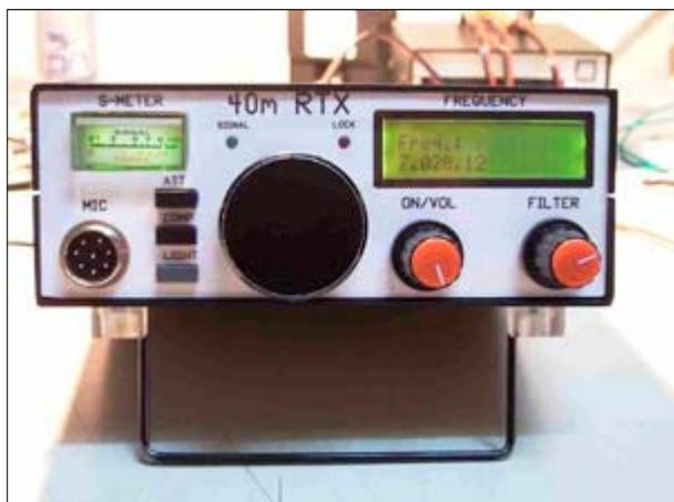
L'RX utilizza come front end un NE612 piazzato subito dopo il filtro passa basso (usato anche dal TX) e ai filtri di banda sintonizzati sui 7MHz. Subito dopo il mixer c'è un filtro a quarzi a 4 poli tagliato per l'SSB (il forty è nato solo per l'SSB) seguito da uno stadio amplificatore e da un altro NE612 utilizzato come demodulatore SSB. Infine c'è l'amplificatore di BF (un LM386) la cui uscita oltre che pilotare l'altoparlante è utilizzata per gestire il circuito di AGC.
