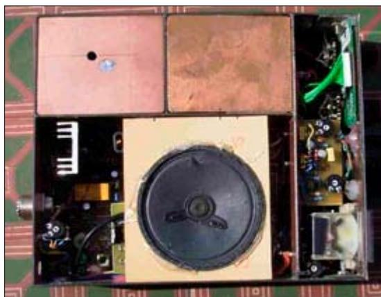
L'RTX era virtualmente finito, ma poter ricevere il CW e poter trasmettere solo in SSB era un vero peccato. Ho quindi realizzato un piccolo oscillatore sinusoidale a circa 800 Hz posto all'ingresso microfonico e comandato dal tasto telegrafico. Ovviamente il tasto controlla anche tutte le commutazioni e il side tone in altoparlante.
