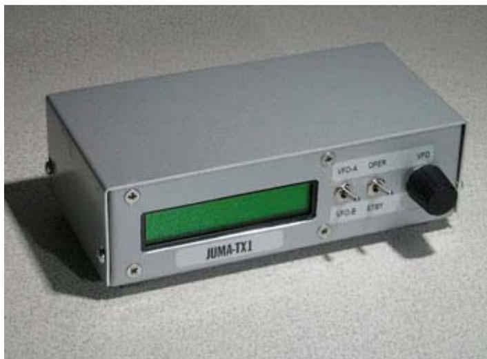
Tenere sotto controllo le nostre batterie si rende necessario quando siamo in trasferta ed alimentiamo il TX a pile, rendendosi necessaria una batteria da almeno 12 Volt e capace di erogare almeno 1,5 A.
