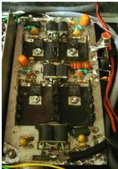
Essendo Noi amanti del QRP ho scelto di pilotarlo con 500 milliwatt ed avere quindi 10 watt di picco in uscita. Ho in seguito aggiunto una ventolina da 12 volt ( di quelle in miniatura usate sul processore dei PC) ma alimentata a 5 volt, che aspira l'aria tiepida sopra il finale e la butta fuori dal Rack 1 U.
